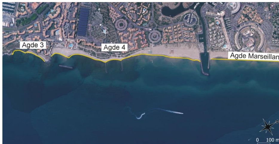
Figure 3 : illustration du découpage des cellules selon les obstacles au transit pour la dérive littorale (ici obstacles naturels de type cap rocheux et artificiels avec digues de port sur la partie est du cap d'Agde)
