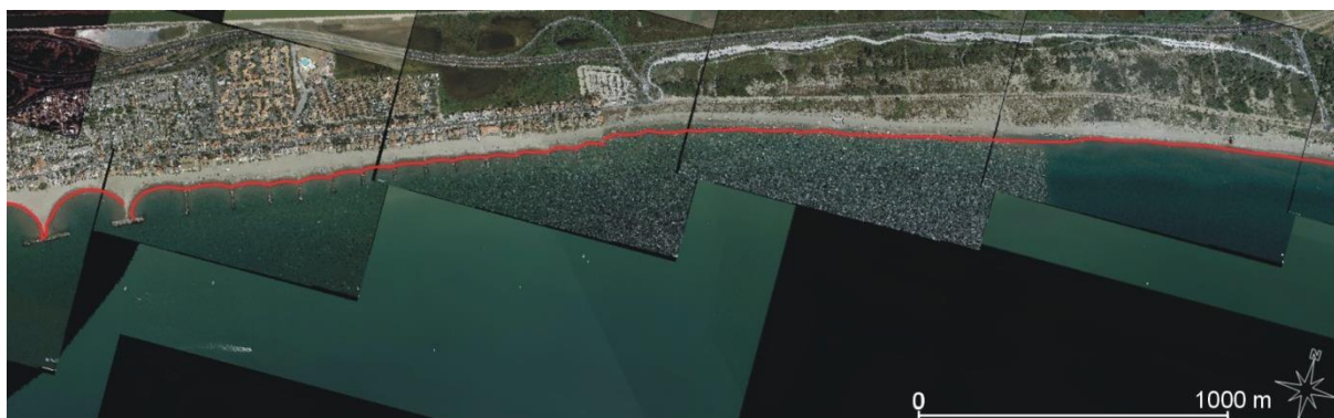
Figure 33 : encoche d'érosion du Petit Travers lié au blocage du sable par les ouvrages dans le sens de la dérive (trait rouge = 2009 ; images fond de carte = Google Earth 2018)
