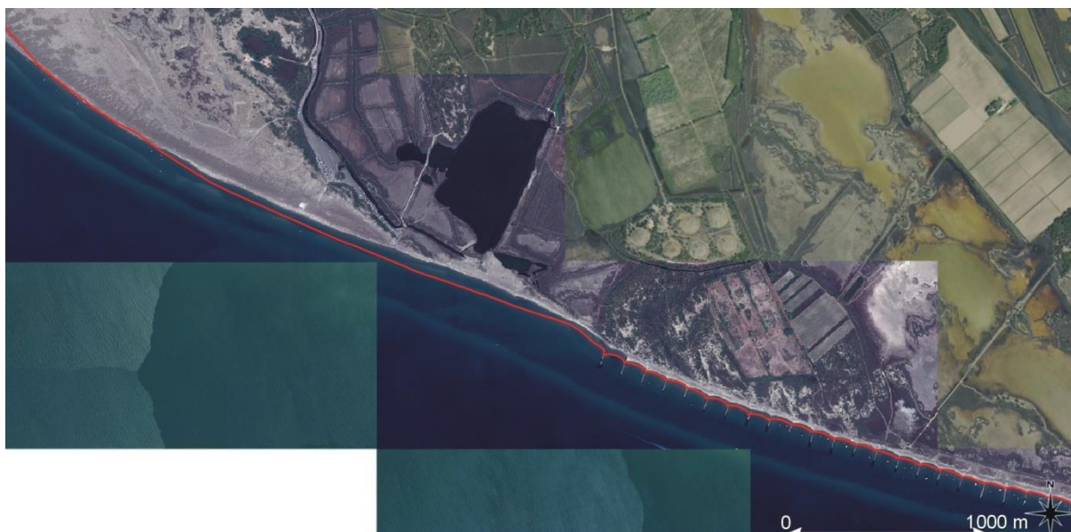
Figure 9 : illustration de la zone la plus en recul localement de toute la région Occitanie ces dix dernières années : l'encoche d'érosion aval-dérive des épis sur le secteur des Baronnets à l'Espiguette d'agrandit nettement, avec en rouge le trait de côte de 2009 positionné sur les ortho-images récentes de Pléiades de l'été 2018 (les différentes couleurs de terrain correspondent à différentes dalles liées à la donnée d'origine).
