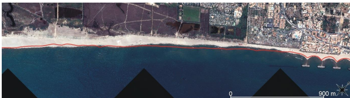
Figure 26 : illustration zoomée de l'encoche d'érosion de Vendres au nord-est après les brise-lames de Valras (trait rouge = 2009 ; image = Pléiades 2018)
