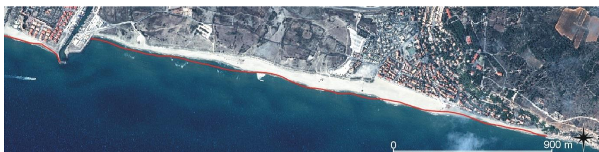
Figure 20 : Le site de très forte érosion de Leucate-plage et de son site sud du Mouret (trait rouge = 2009 ; image = Pléiades 2018)
