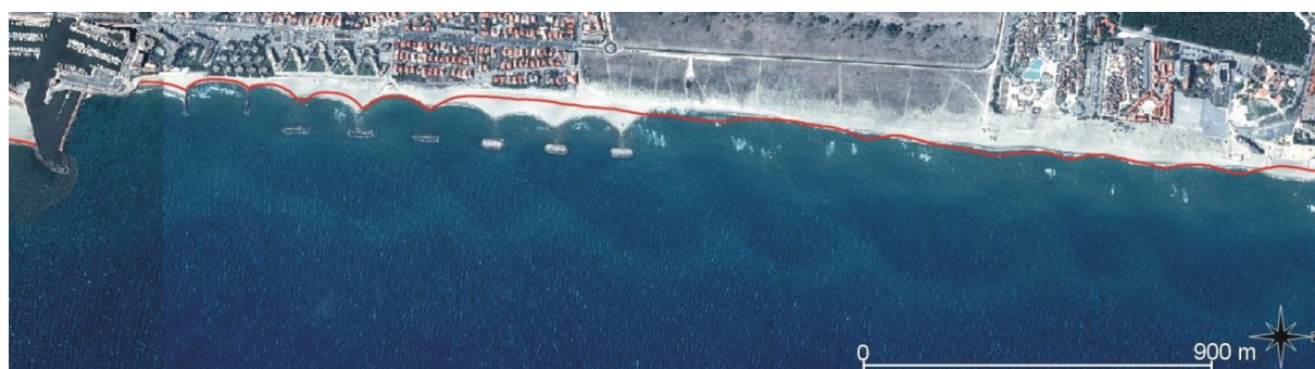
Figure 19 : Plage sud du Barcarès avec l'effet de décalage de l'encoche d'érosion vers le nord (trait rouge = 2009 ; image = Pléiades 2018)
