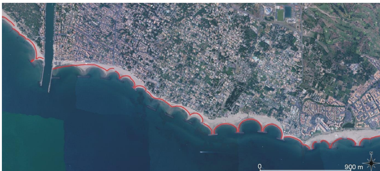
Figure 28 : illustration du phénomène de dépôt à Agde lié en grande partie aux aménagements du Grau d'Agde à l'Est de l'embouchure (trait rouge = 2009 ; image = Pléiades 2018)
