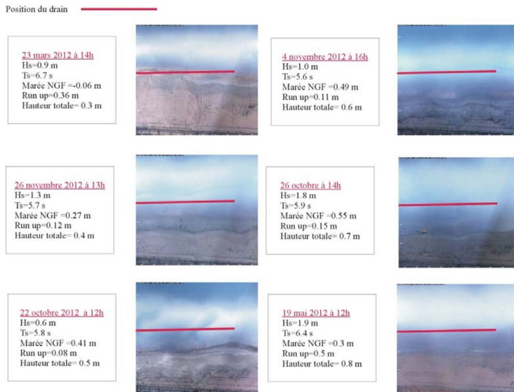
Illustration 36 - Position du drain pour différentes conditions hydrodynamiques. On note que pour des niveaux d'eau maximaux compris entre 0.3 et 0.8 m, la zone de battement du jet de rive (en blanc) est localisée au-dessus du drain.
