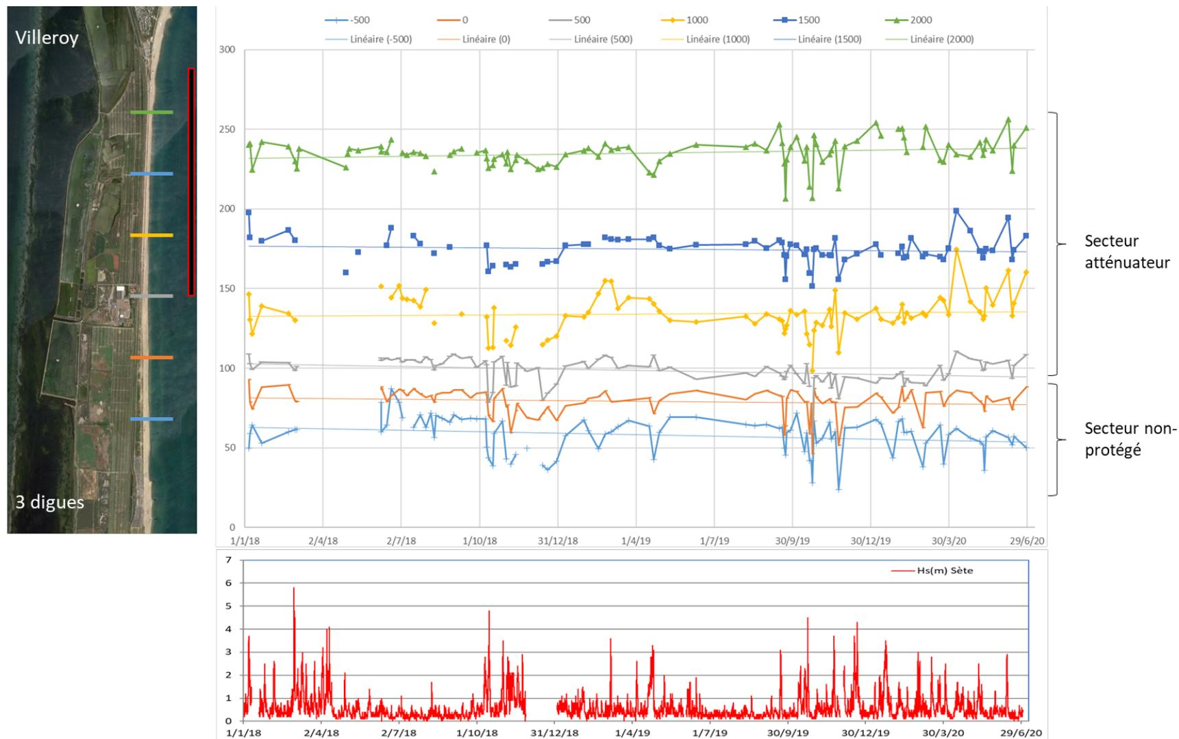
Illustration 21 – Evolution temporelle de la position du trait de côte sur des profils transverses dans la zone située derrière l’atténuateur et dans la zone adjacente non protégée au SO. La série temporelle des hauteurs de vagues au large est représentée en dessous pour localiser les événements de tempêtes.
