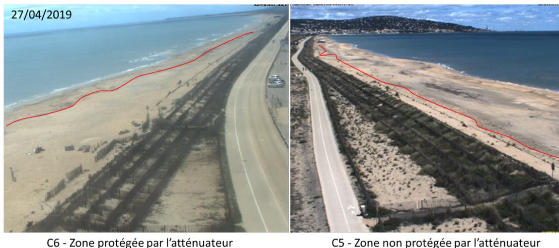
Illustration 33 – Images des caméras 5 (à droite) et 6 (à gauche) illustrant respectivement les positions des lasses de mer de la tempête (ligne rouge) dans le secteur non protégé (à droite) et protégé (à gauche) par l'atténuateur.
