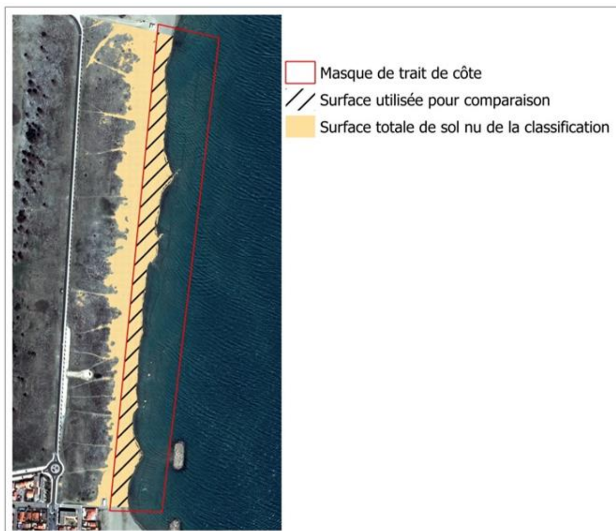
Figure 11 : Exemple d'utilisation du masque de trait de côte pour éviter le biais de classification sur la dune.
