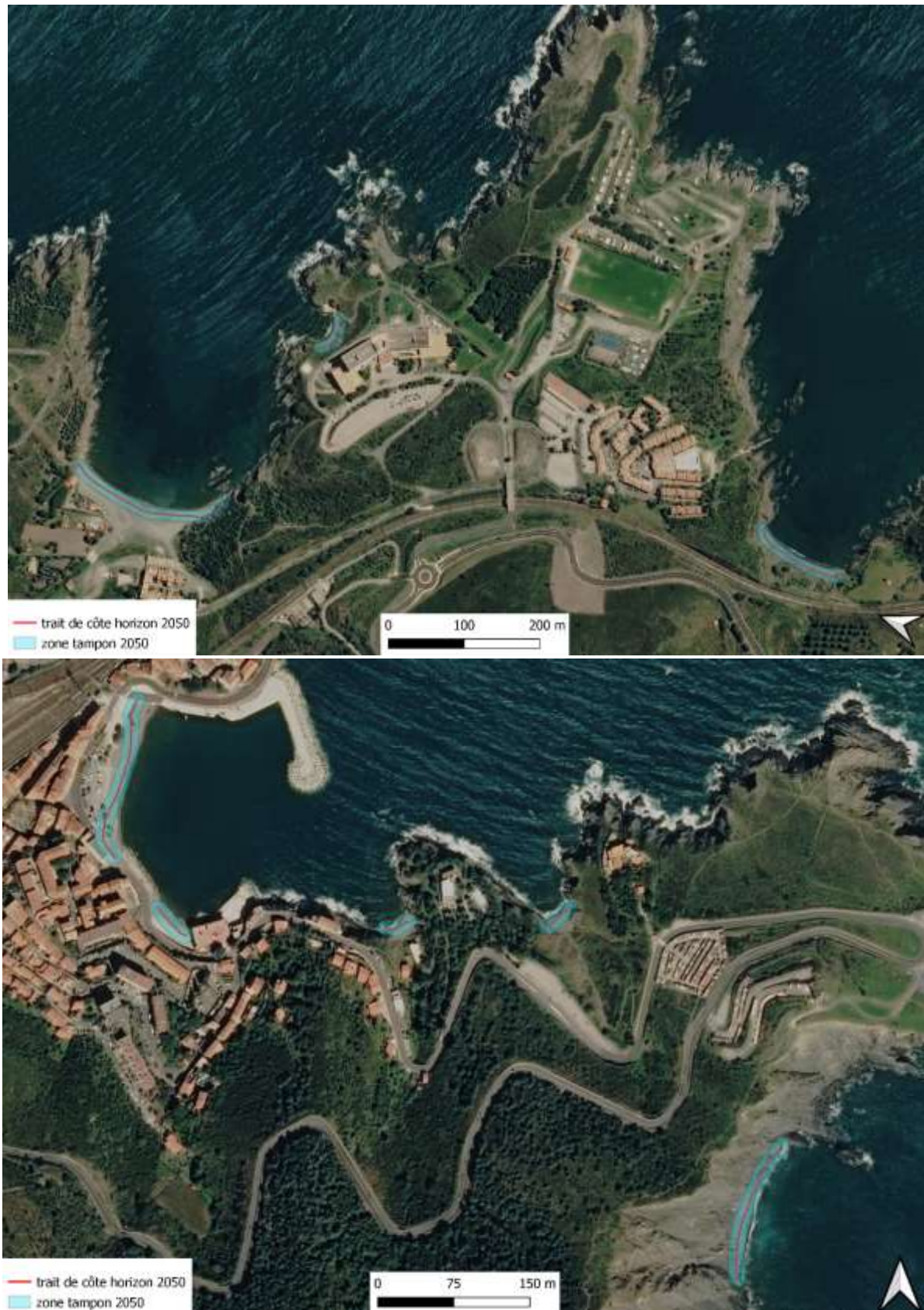
Figure 33 : Projection à l'horizon 2050 du trait de côte pour les plages du nord (haut) et du centre de la commune de cerbère (bas)
